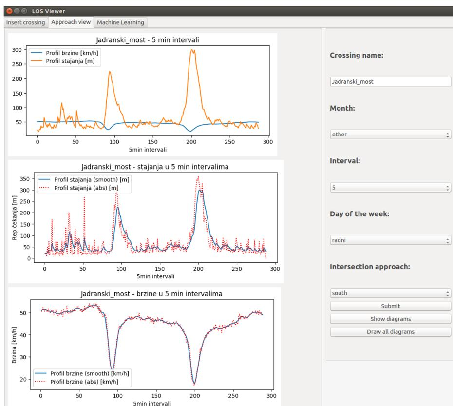
Slika 5.7: GUI - prikaz repova čekanja i profila brzina
