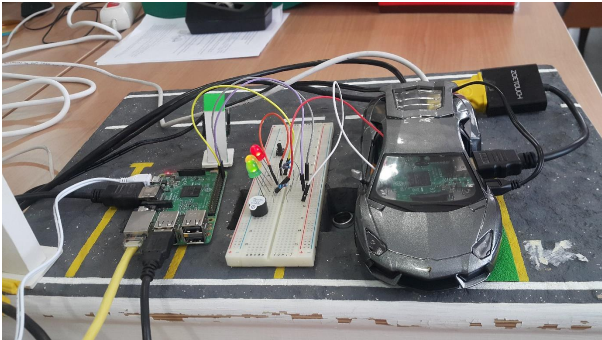
Slika 30. Simulacija punjenja električnog vozila
