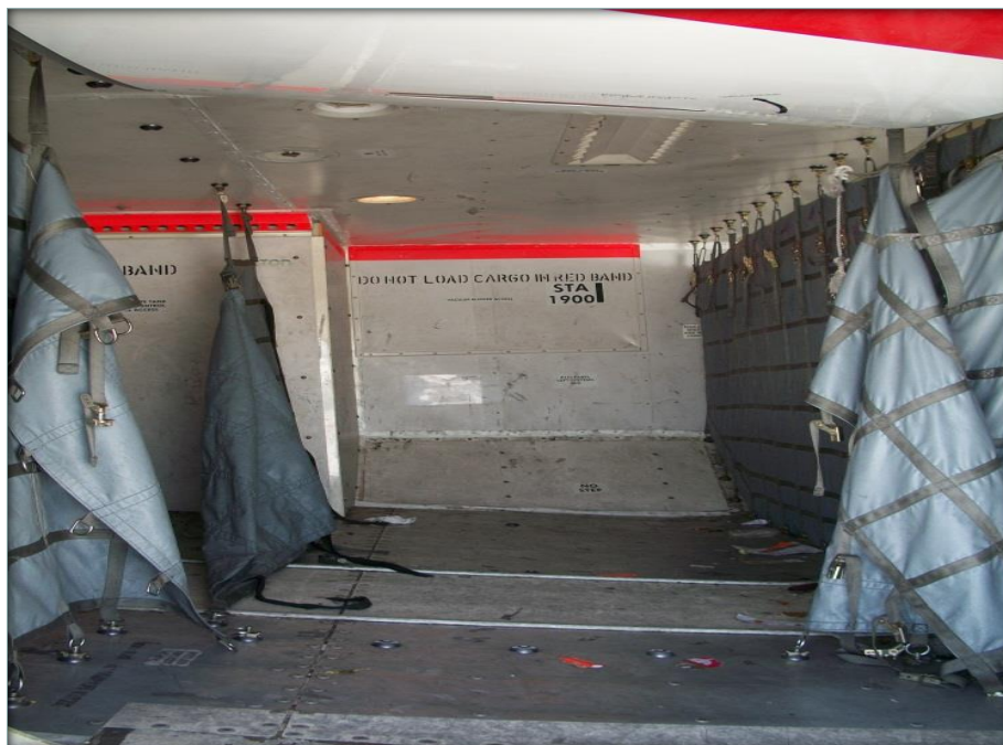
Slika 23. Prtljažnik za komadnu prtljagu zrakoplova B777
