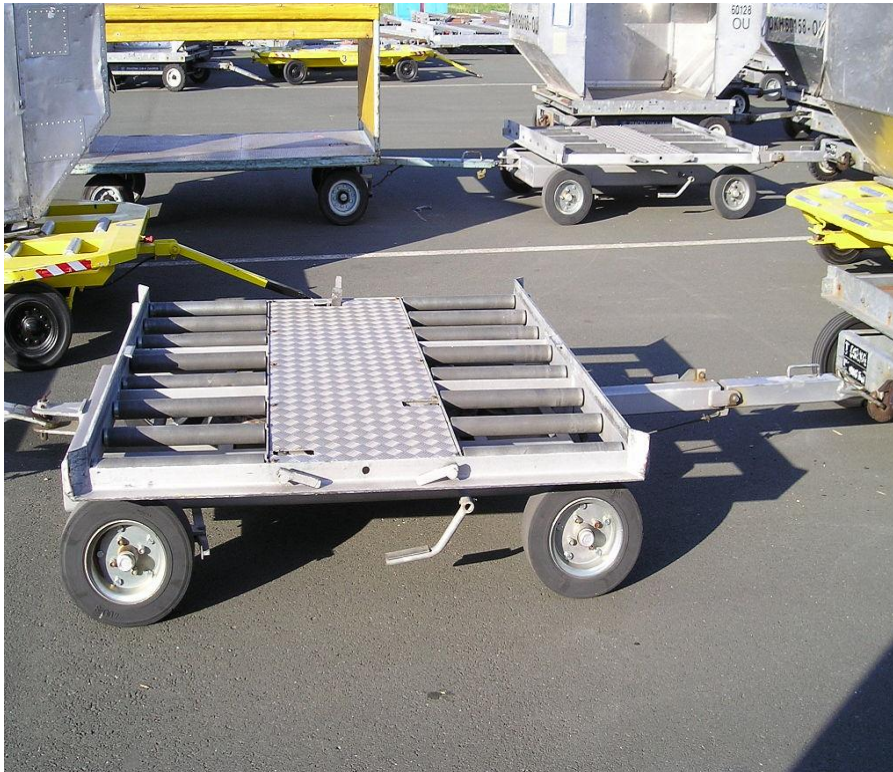
Slika 7: Kolica za prijevoz kontejnera
