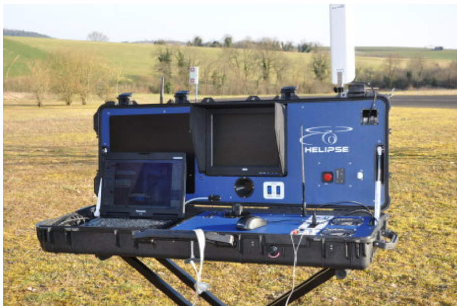
Slika 10. Zemaljska stanica za kontrolu proizvođača HELIPSE
