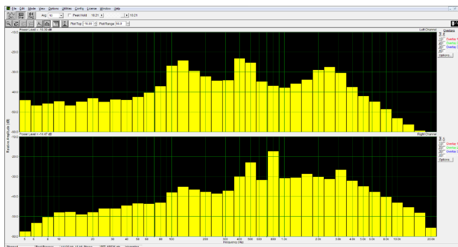
Slika 5.5. Primjer prikaza spektara mjernog (gore) i referentnog senzora (dolje)
