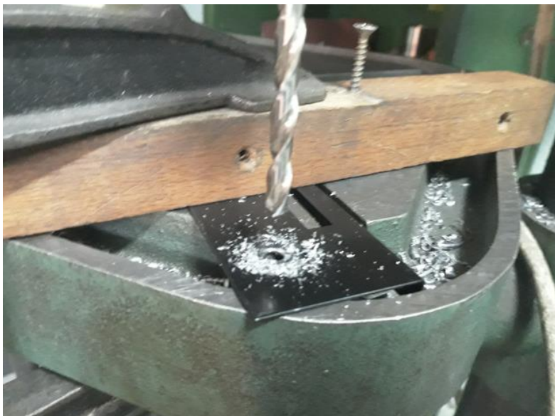
Slika 4.13. Fotografija bušenja rupe za sklopku na stupnoj bušilici
