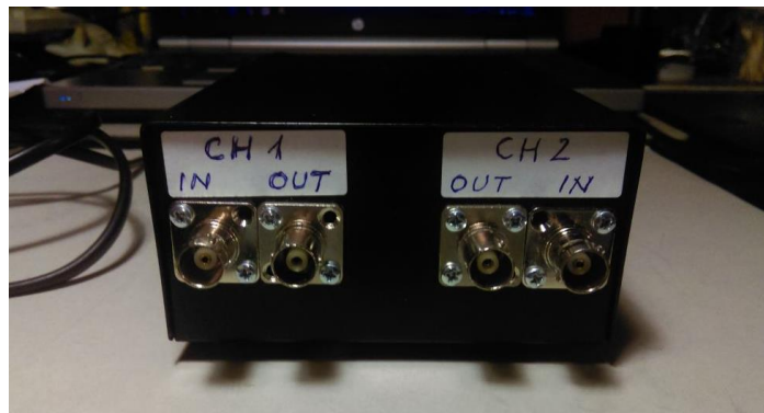
Slika 4.20. Završeno kondicijsko pojačalo s dva zasebna kanala
