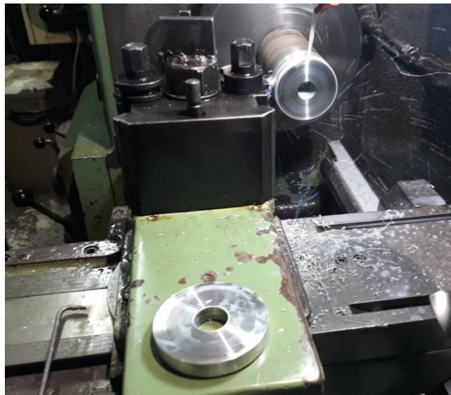
Slika 4.32. Rezanje montažnih diskova na tokarilici
