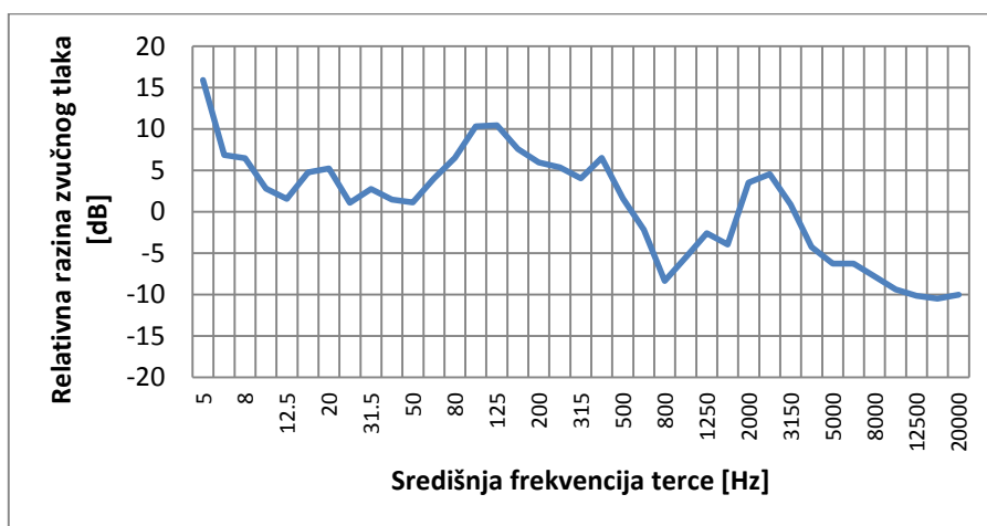
Grafikon 5.1. Vrijednosti razine zvučnog tlaka po tercama za S3 pri 40 čvorova i napadnom kutu 20° (pri transfernoj funkciji L/R)
