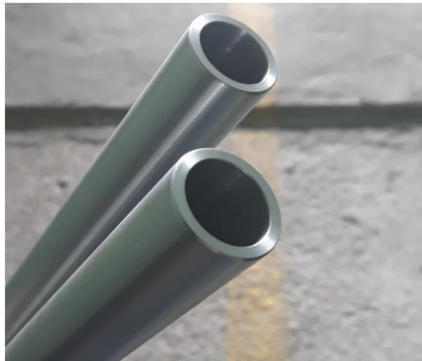
Slika 4.29. Osovine nakon obrade
