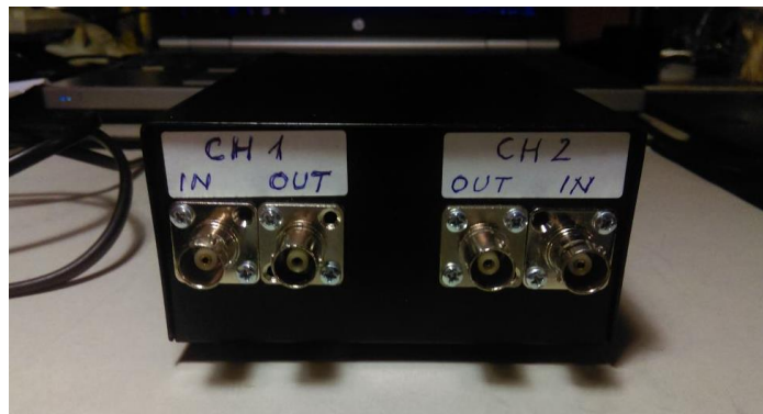
Slika 4.20. Završeno kondicijsko pojačalo s dva zasebna kanala
