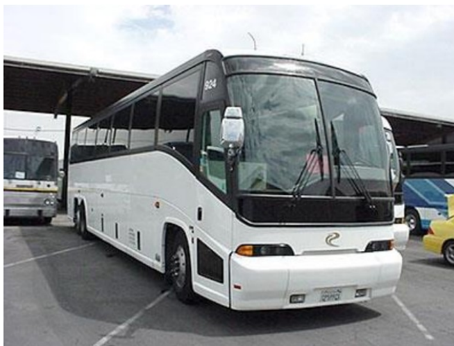
Slika 9. Primjer standardne izvedbe troosovinskoga autobusa za međugradski linijski promet
