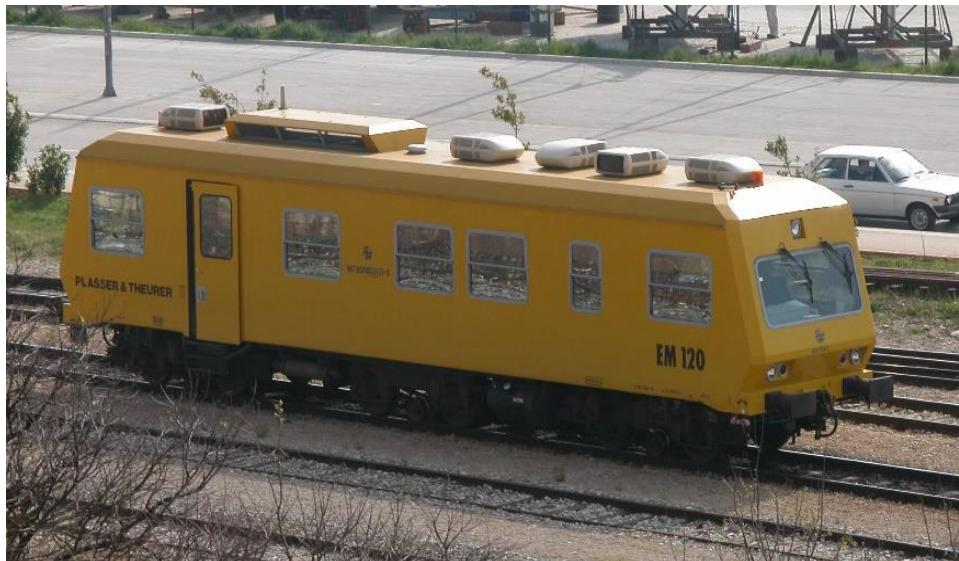
Slika 2. Tračničko mjerno vozilo EM-120, [6]
