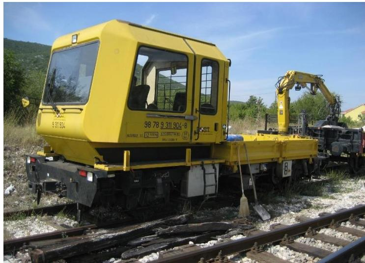
Slika13: Teška motorna drezina SKL 26, [9]
