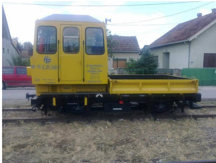
Slika 12. Teška motorna drezina SKL 25, [9]
