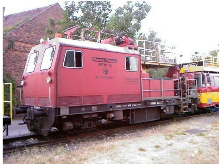
Slika 17. Teška motorna drezina MTW 10, [11]
