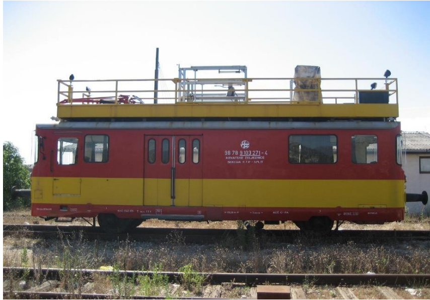
Slika 16. Teška motorna drezina tipa 300 "Boris Kidrič" Maribor, [11]
