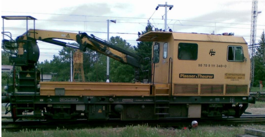
Slika 9: Teška motorna drezina Plasser&Theurer OBW-10.268, [7]
