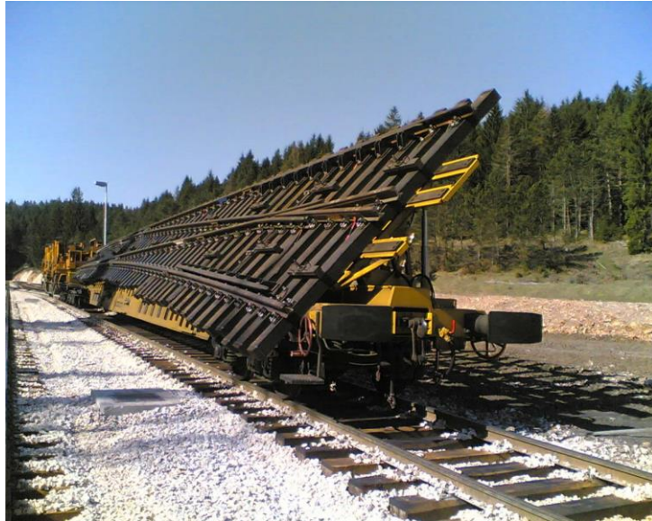
Slika 7. Vozilo za prijevoz skretnice, [8]
