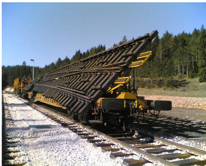
Slika 7. Vozilo za prijevoz skretnice, [8]
