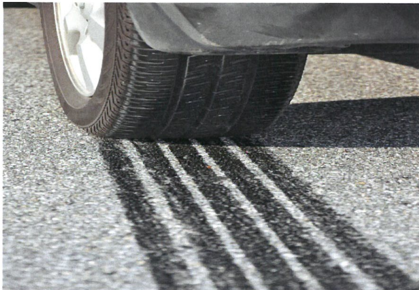
Slika 2. Trag kočenja neblokiranih kotača vozila [13]
