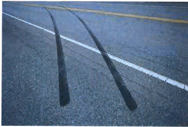
Slika 3. Tragovi kočenja s blokiranim kotačima [14]
