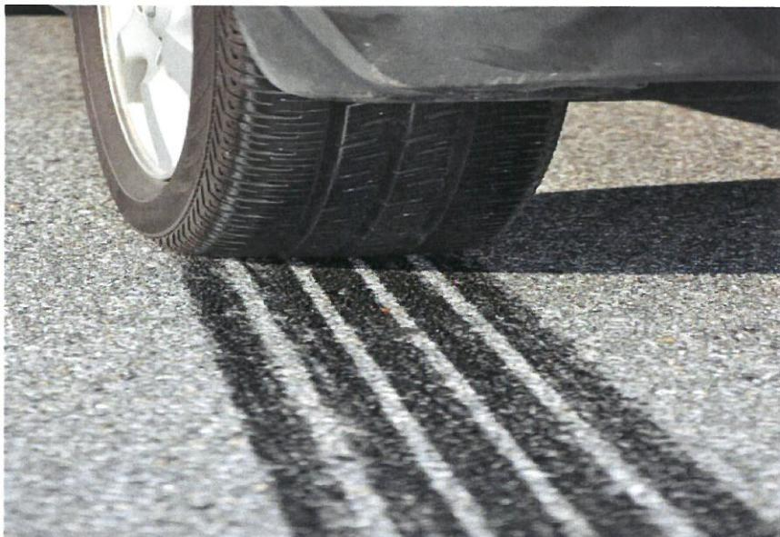
Slika 2. Trag kočenja neblokiranih kotača vozila [13]
