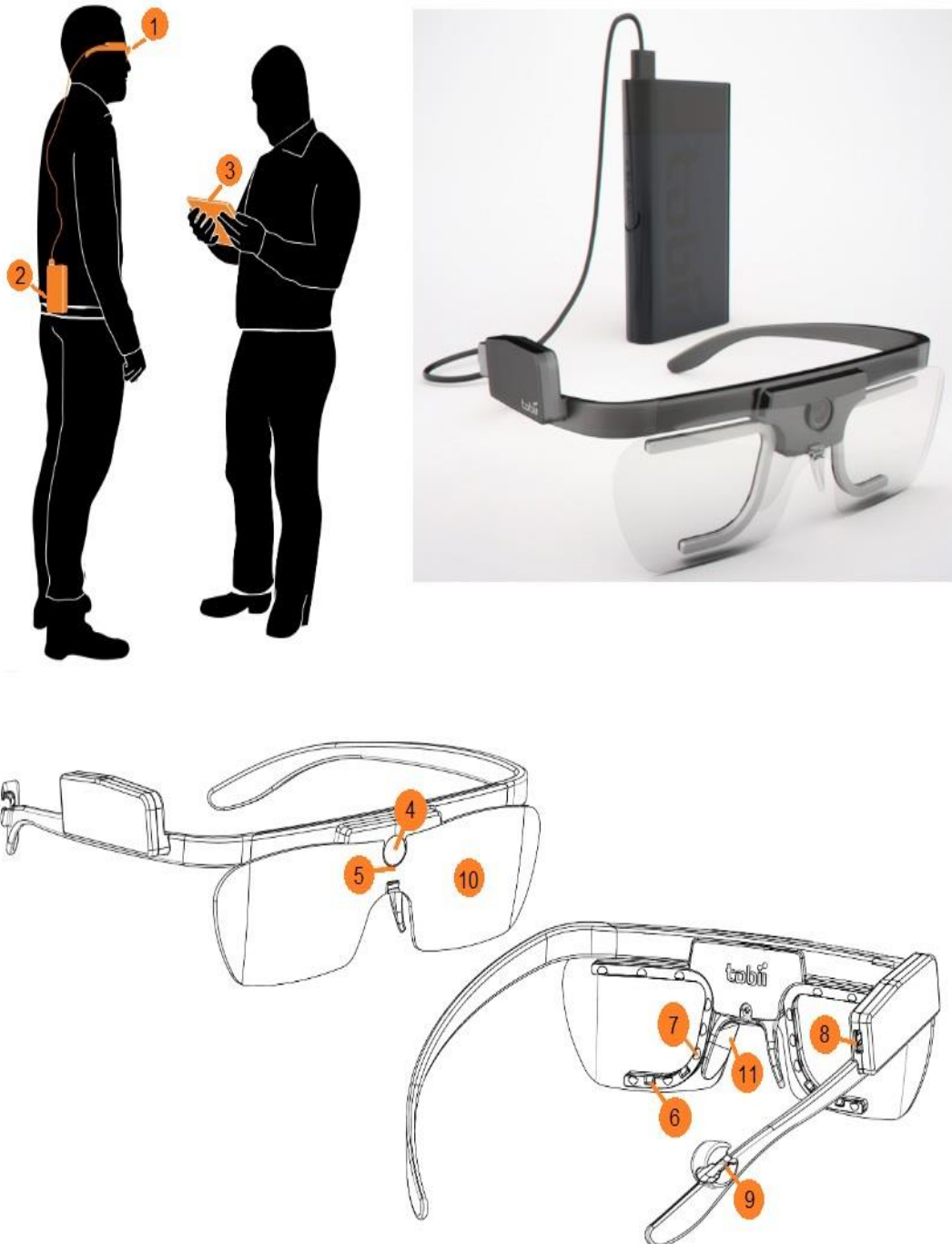
Slika 17. Komponente naočala Tobii Pro Glasses 2
