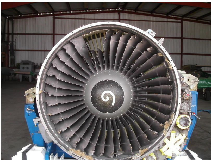
Slika 4.2: Oštećenje lopatica mlaznog motora uslijed usisavanja ptice
