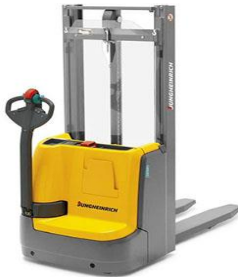
Slika 7. Ručni baterijski viličar s kranom ECJ 110/112
