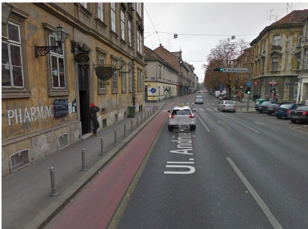
Slika 29. Jednosmjerna biciklistička traka u ulici Andrije Hebranga u Zagrebu vođena sa lijeve strane kolnika
