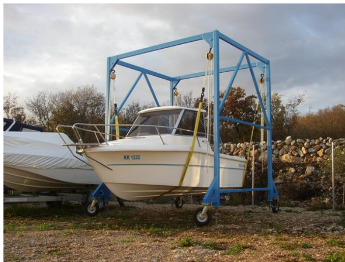
Slika 8. Prikaz opreme suhe marine za podizanje i spuštanje plovnog objekta
