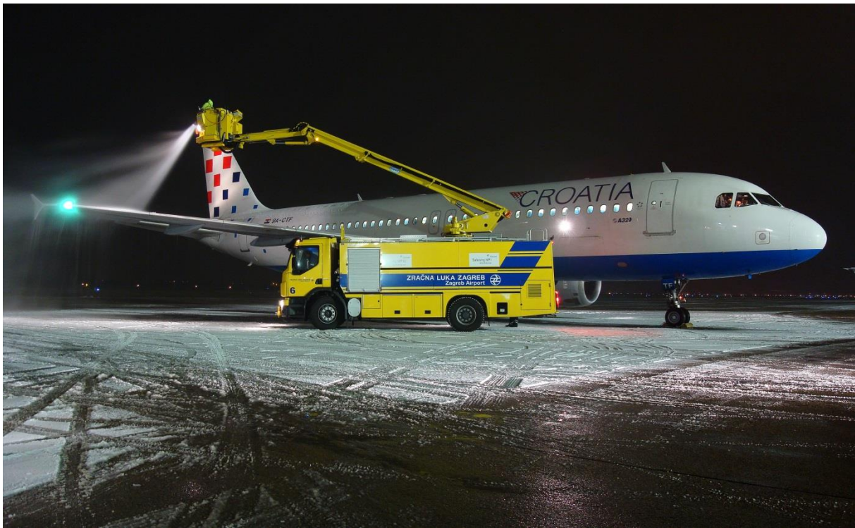
Slika 5. Zaštita zrakoplova od zaleđivanja
