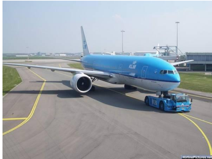
Slika 18: Vozilo za izgurivanje zrakoplova
