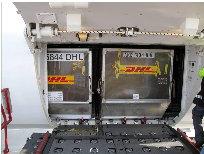
Slika 14: ULD kolica sa fiksnom platformom i kugličnim sustavom
