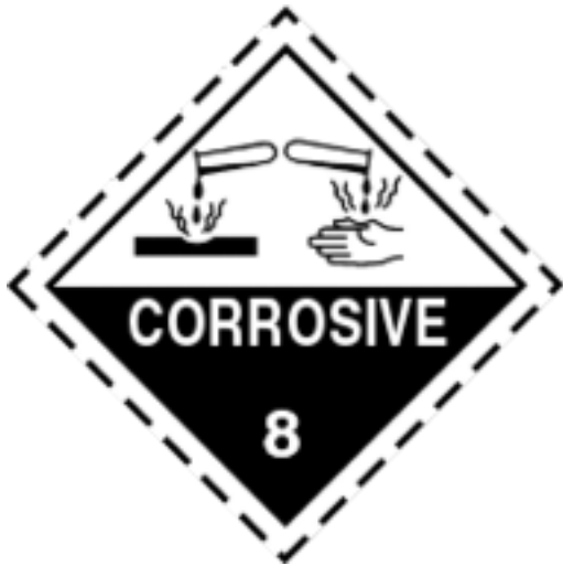
Slika 20. Naljepnica za označavanje korozivnih tvari 20
