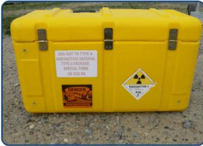
Slika 28. Primjer pakiranja tipa A za radioaktivne tvari klase III 50
