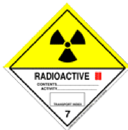
Slika 2.21: Oznaka za radioaktivni materijal kategorije II - žuto
