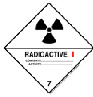
Slika 2.20: Oznaka za radioaktivni materijal kategorije I - bijelo
