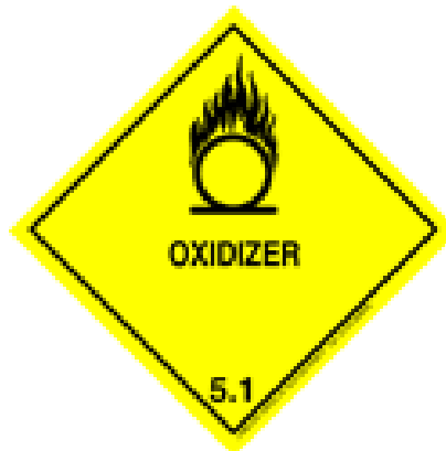
Slika 2.16: Oznaka za oksidirajuće tvari
