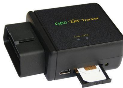
Slika 27: OBD dongle s GPS lokatorom i SIM karticom
