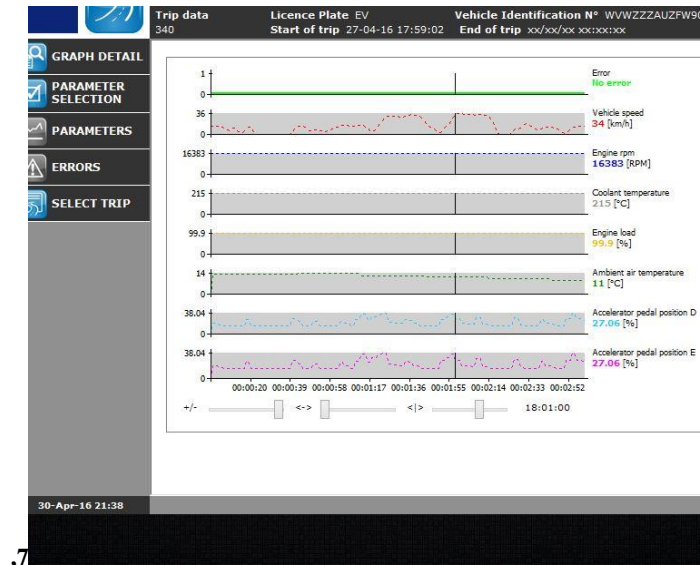
Slika 39: Prikaz parametara zabilježenih OBD Log-om, VW Golf
