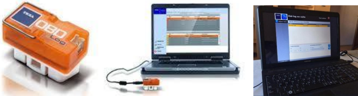
Slika 34: Prikaz spajanja OBD Log-a na računalo (prijenos podataka), [27]
