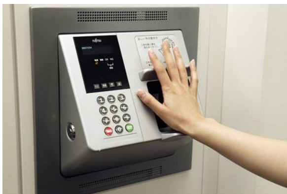
Slika 17: Primjer uređaja za skeniranje geometrije dlana Izvor: www.gradimo.hr
