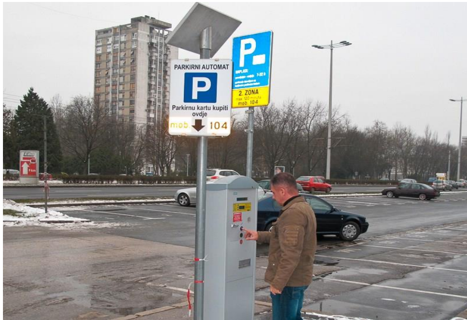
Slika 7. Naplatni uređaj sa solarnim panelom [11]
