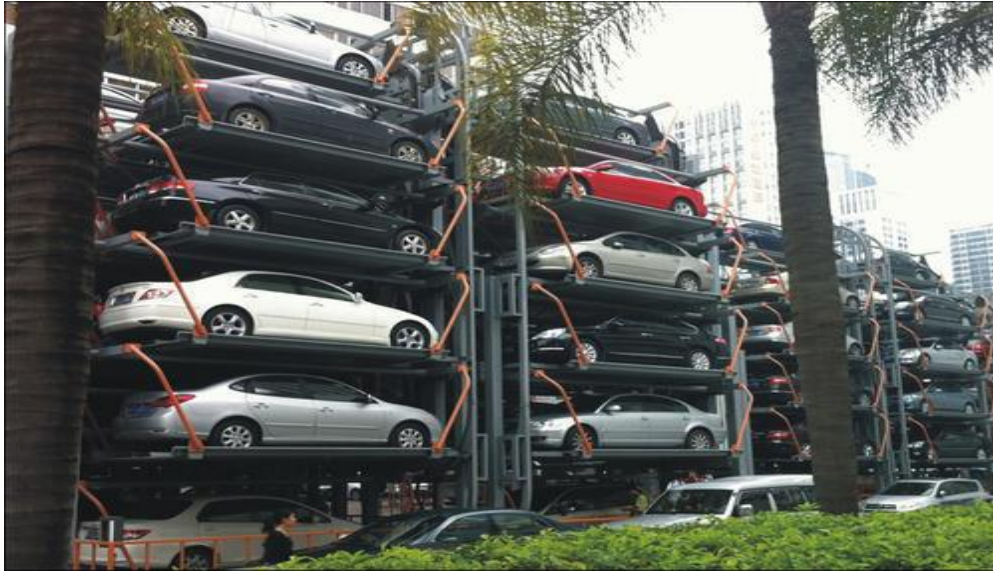
Slika 12. Rotacijski tip parkirnog sustava[13]
