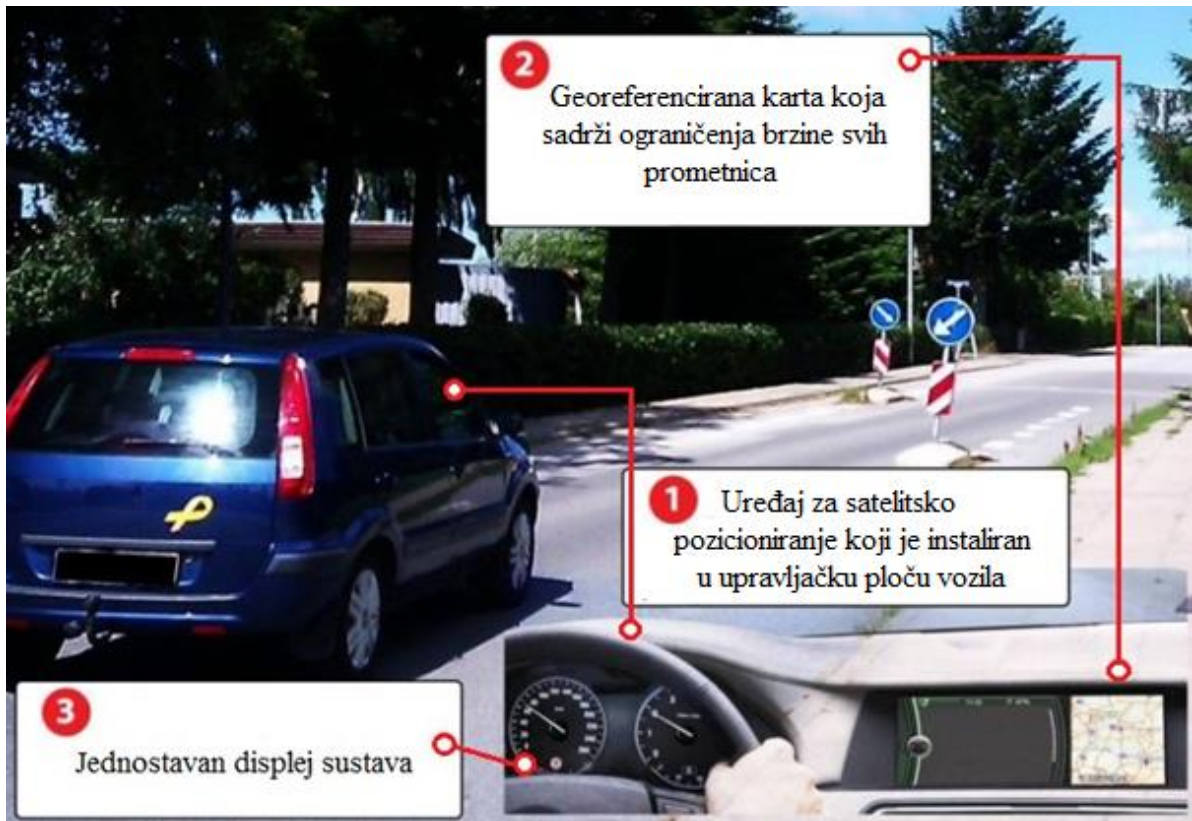
Slika 14: Inteligentni sustav pomoći za poštivanje ograničenja brzine [22]
