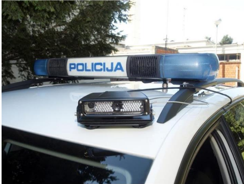
Slika 11: Sustav za automatsko prepoznavanje registarskih oznaka [26]
