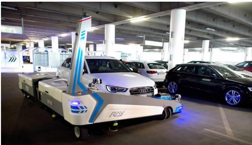
Slika 17. Prikaz sustava parkiranja vozila pomoću robota
