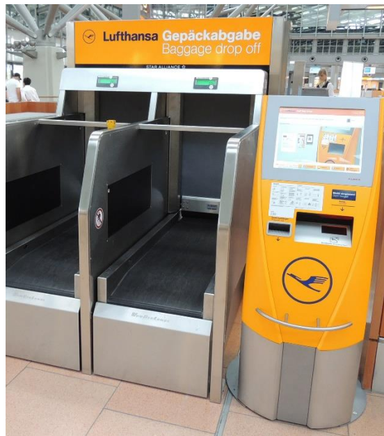
Slika 20. Samoposlužni uređaj za prijavu i predaju prtljage na let
