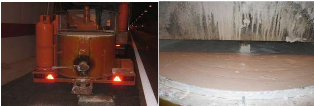
Slika 29. Proces pripreme termoplastičnih materijala
