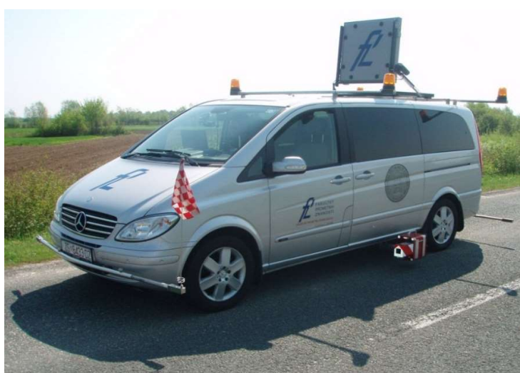
Slika 40. Mjerno vozilo sa Zavoda za prometnu signalizaciju Fakulteta prometnih znanosti, Sveučilišta u Zagrebu s montiranim dinamičkim retroreflektometrom
