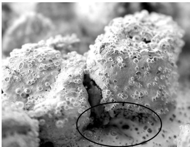
Slika 13. Prikaz retroreflektirajućega materijala ispod „brežuljka” pri hrapavim kolnicima
