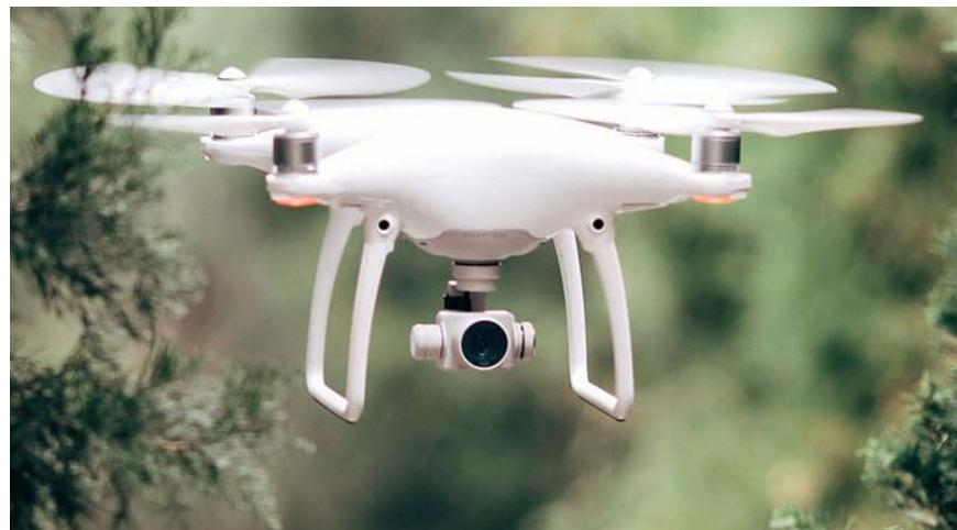
Slika 15. Kardanski prsten na bespilotnoj letjelici Phantom 4 [25]
