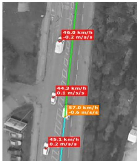
Slika 26. Prikaz mjerjenja brzina [11]
