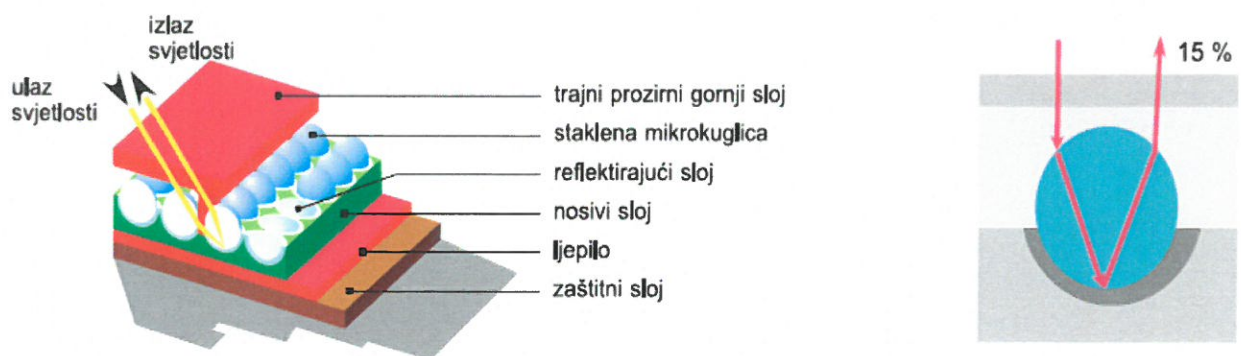
Slika 6. Struktura folije i način reflektiranja klase II, [12]
