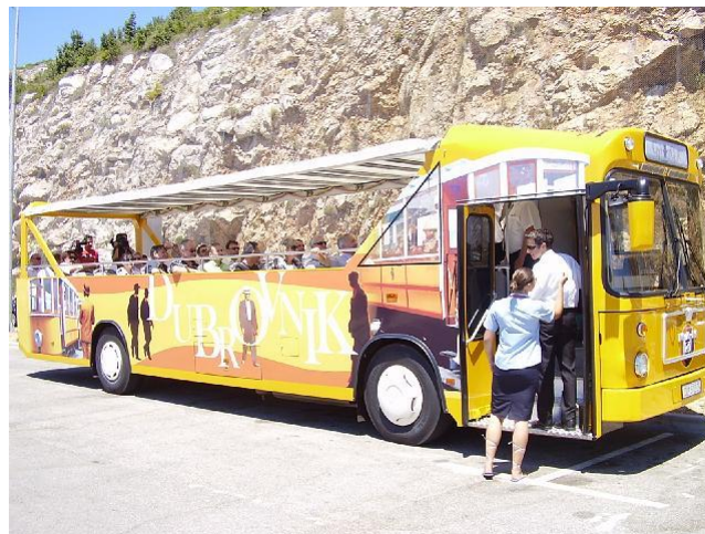
Slika 12. Kabrio autobus, preuređeni gradski autobus marke MAN SU 220
