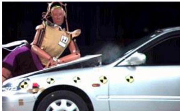
Slika 15. Poklopac motora prilikom udara pješaka[29]
