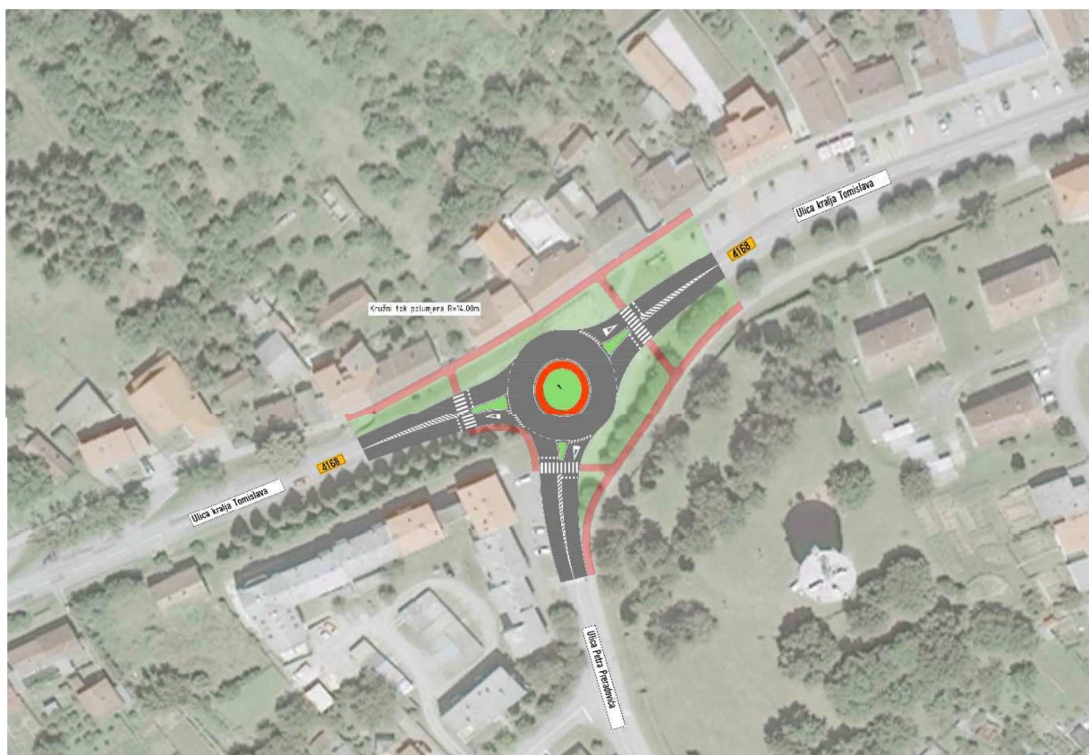
Slika 21. Prijedlog kružnog toka na raskrižju Ulice kralja Tomislava i Ulice P. Preradovića Izvor: [2]
