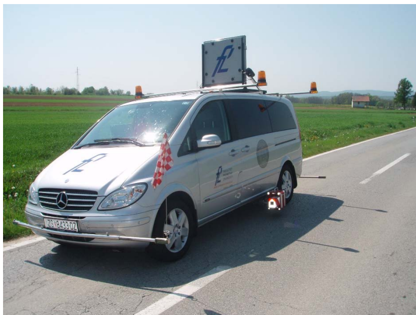
Slika 39. Vozilo za ispitivanje vidljivosti oznaka na kolniku
