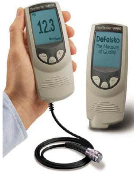
Slika 33. Uređaj za mjerenje debljine suhog filma boje
