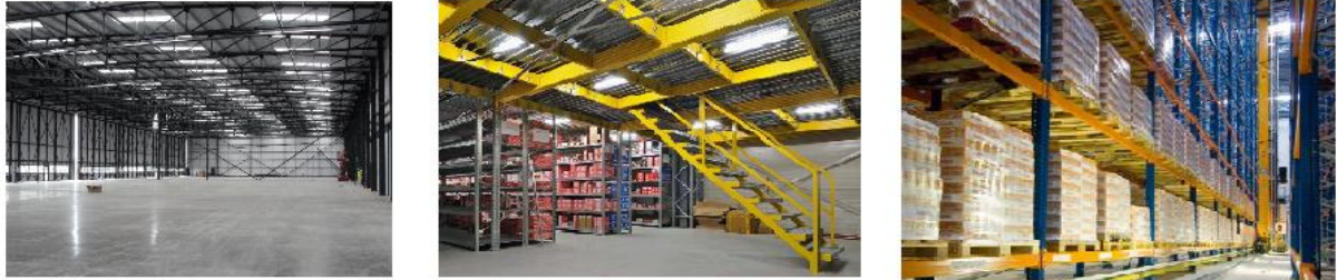
Slika 8: Hangar, etažno skladište i regalno
