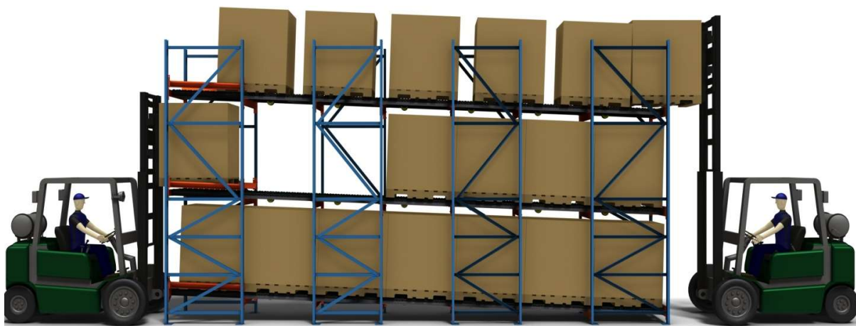
Slika 5. Prikaz protočnih regala sa kotačićima
