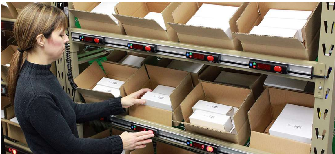
Slika 10.: Prikaz uporabe „pick to light“ sustava
