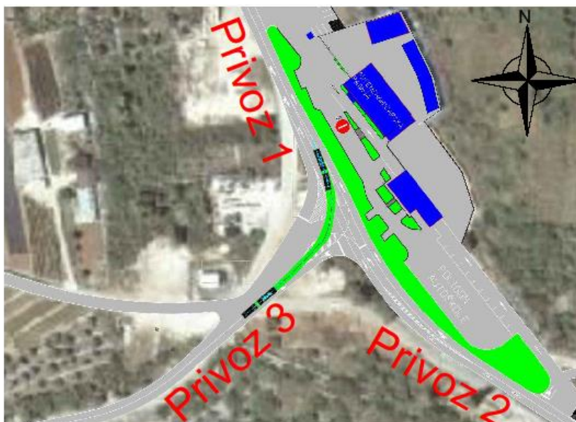
Slika 4.6. Provjera trajektorije mjerodavnog vozila na Ž6222
