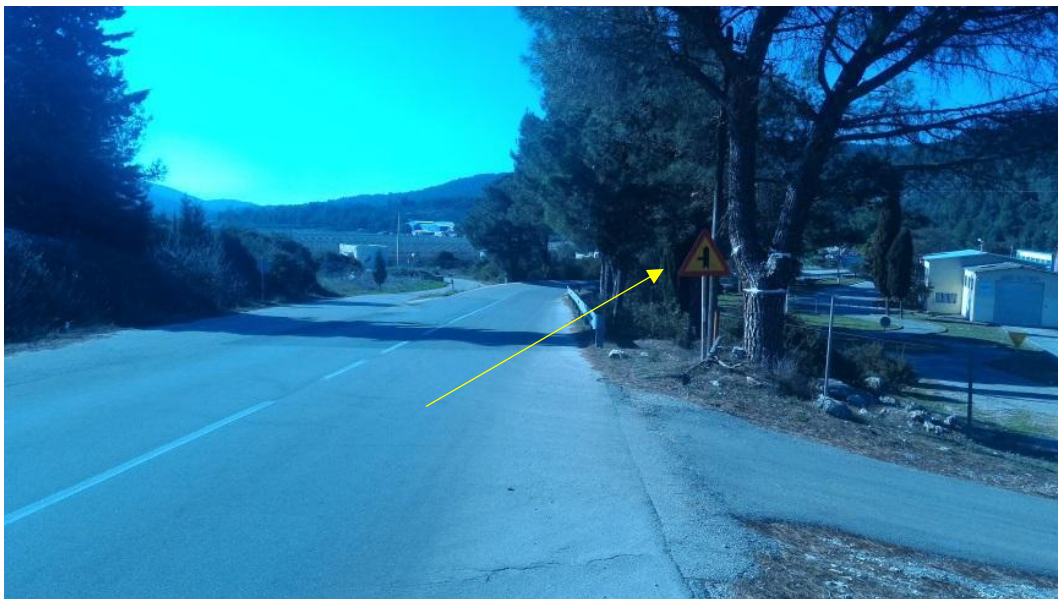
Slika 3.11. Znak A04 - spajanje sporedne ceste pod pravim kutom s lijeve strane
