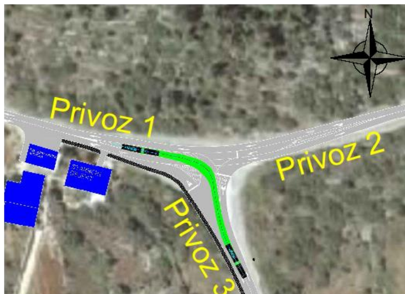
Slika 4.5. Provjera trajektorije mjerodavnog vozila na D118
