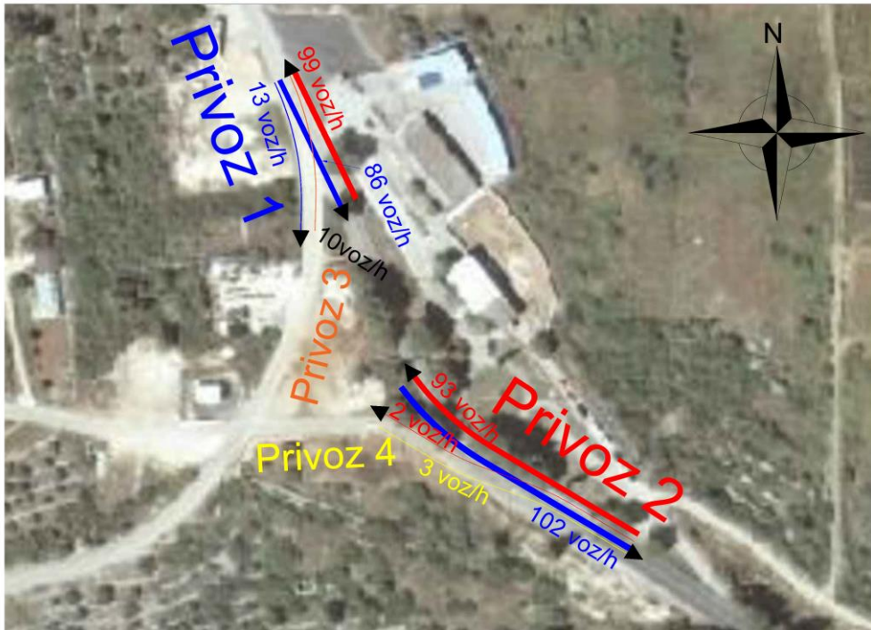
Slika 3.8. Vršno opterećenje po privozima na raskrižju Ž6222/LC69016/Ž6222/nerazvrstana cesta
