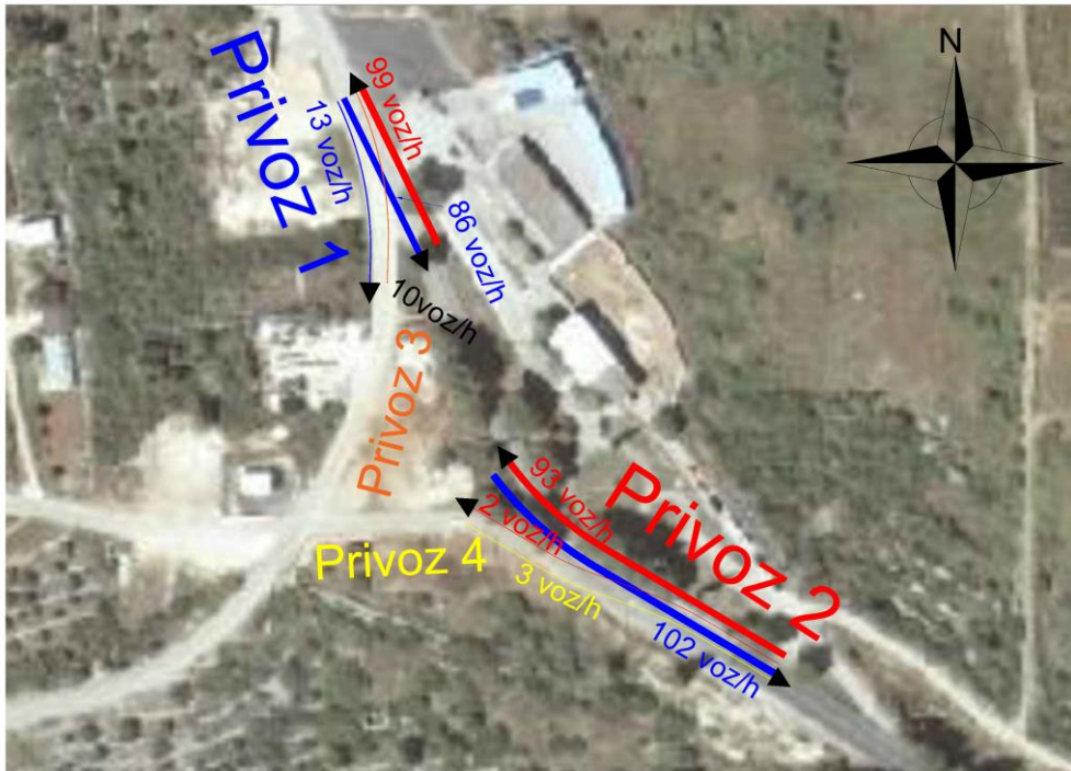
Slika 3.8. Vršno opterećenje po privozima na raskrižju Ž6222/LC69016/Ž6222/nerazvrstana cesta
