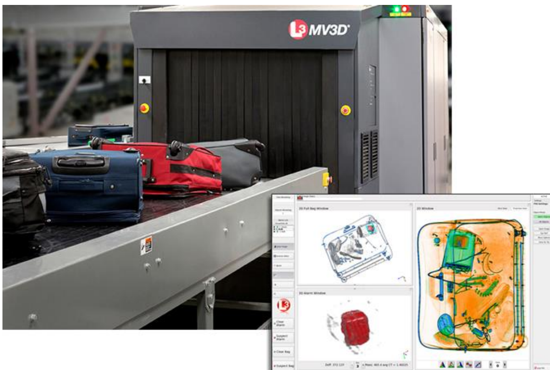
Slika 14. Prikaz EDS MV3D i 2D i 3D slika pregledanih torbi
