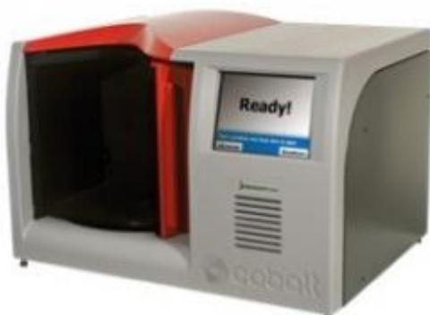
**Slika 8.** Oprema za otkrivanje tekućih eksploziva
