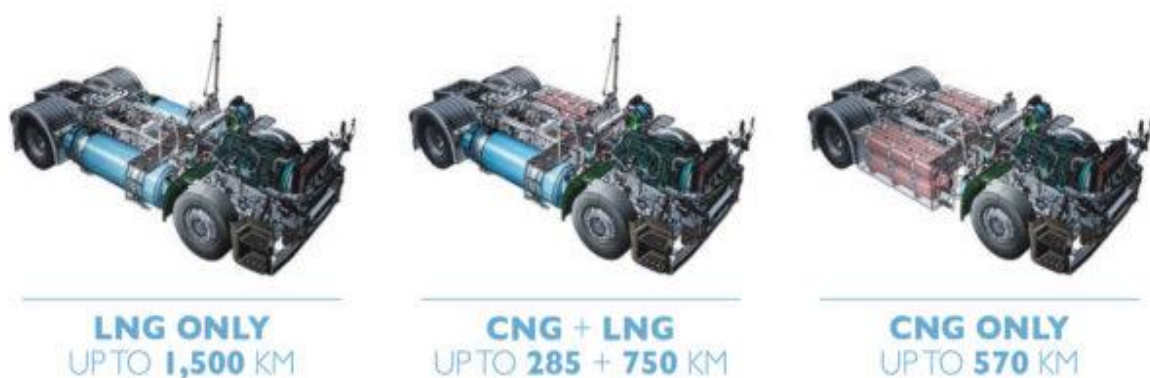
Slika 10. Iveco Stralis i prikaz moguće izvedbe, [10]
