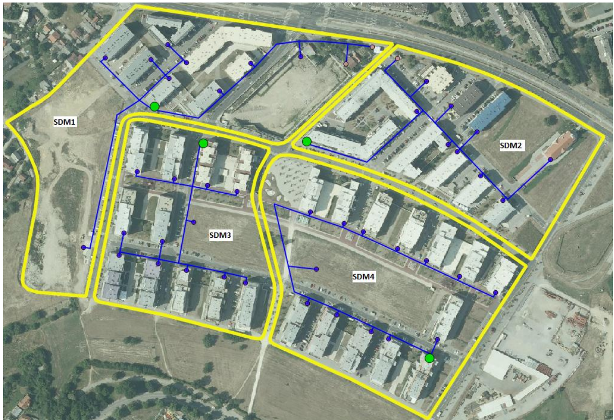
Slika 31. Svjetlovodna distribucijska mreža sa pripadajućim elementima
