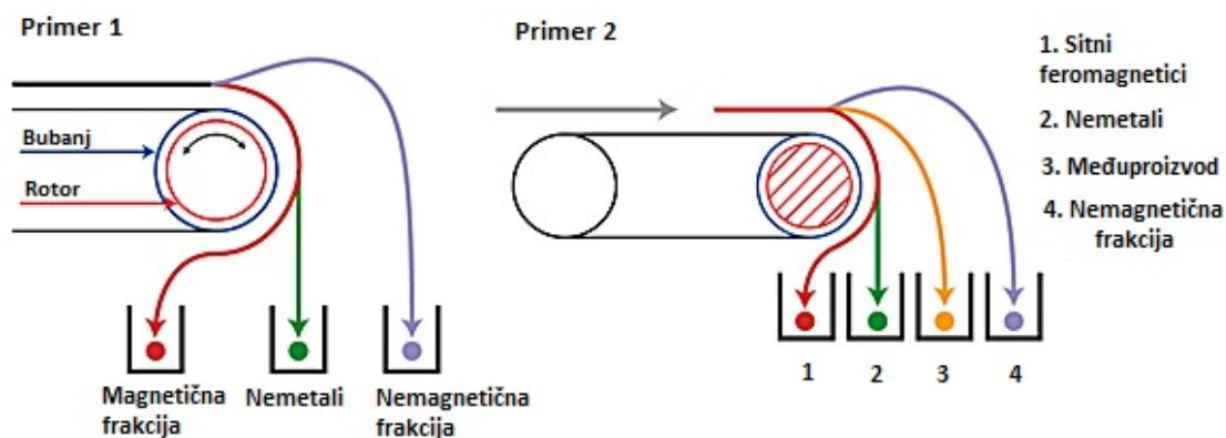
Slika 6. Princip rada Eddy current magnetskog separatora
