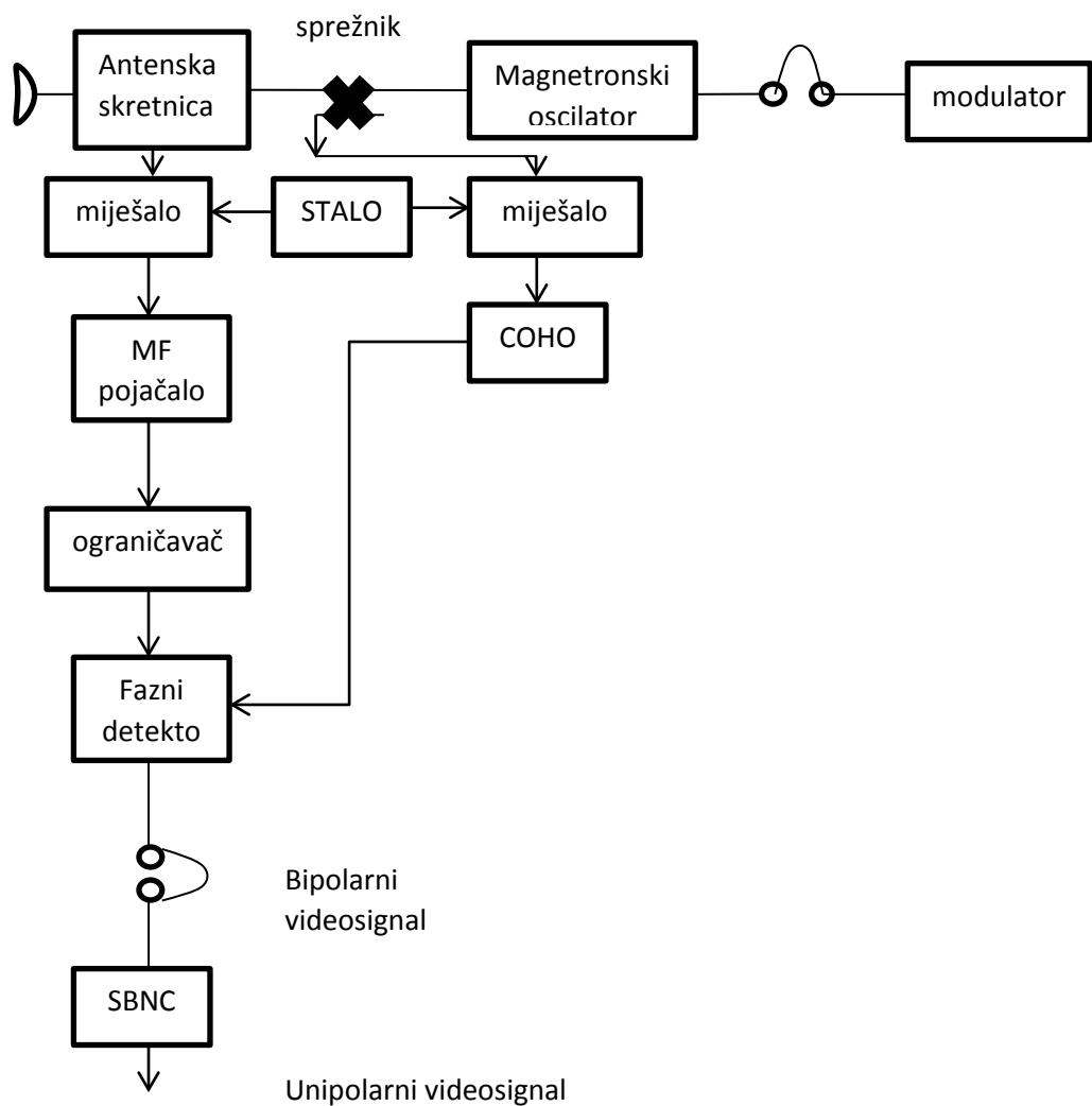
**Slika 20.** Blok shema Dopplerovog radara sa magnetronskim oscilatorom, [1]
