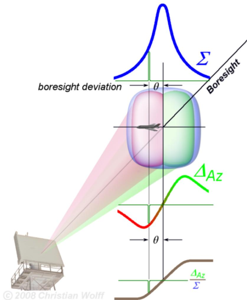
**Slika 16.** Prikaz podjele sigma i delta signala
