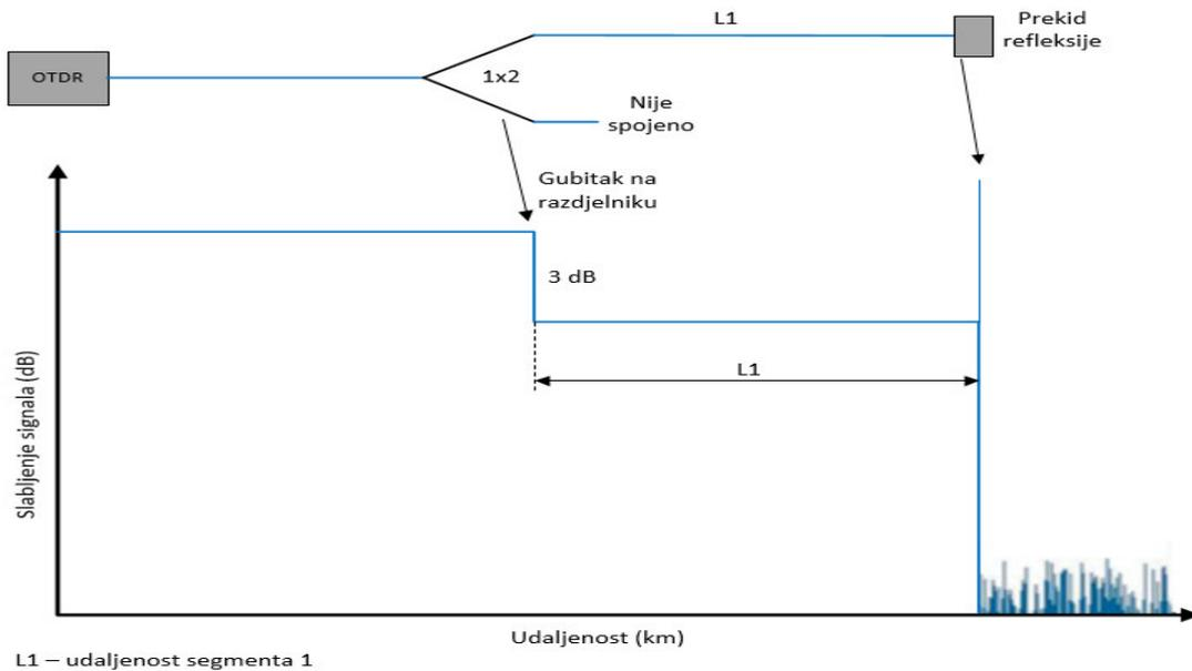
Slika 26: Trag na OTDR-u s 1x2 razdjelnikom sa samo jednim spojenim segmentom
