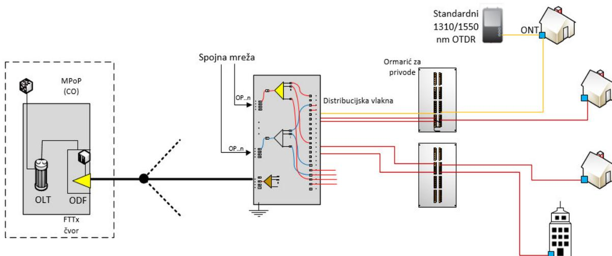
Slika 24: Mjerenje OTDR-om
