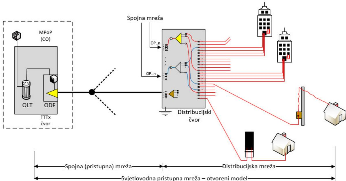
Slika 20: Svjetlovodna mreža građena po otvorenom modelu
