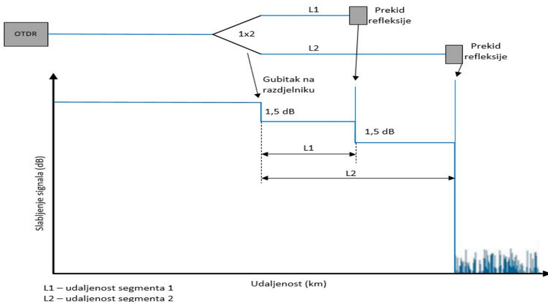
Slika 27: Trag na OTDR-u s 1x2 razdjelnikom s dva spojena segmenta različitih duljina
