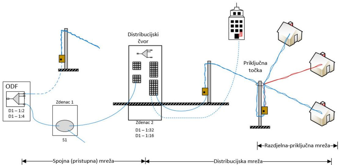
Slika 9: Pozicioniranje distribucijskog čvora kod svjetlovodne zračne mreže
