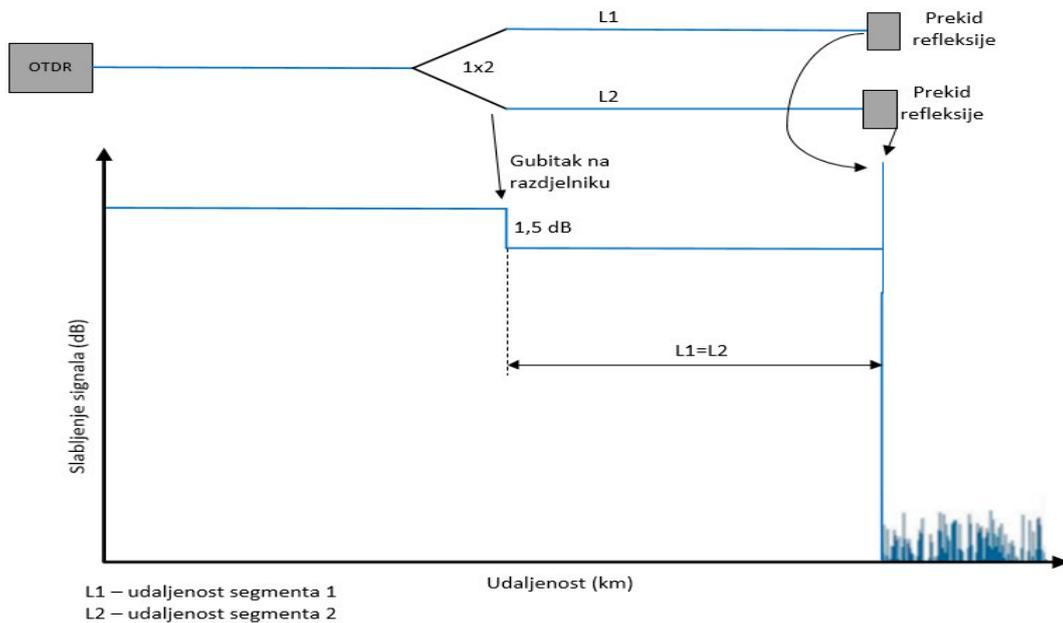
Slika 28: Trag na OTDR-u s 1x2 razdjelnikom s dva spojena segmenta iste duljine
