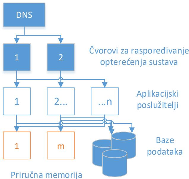
Slika 3. Referentna arhitektura *Cloud Computinga* za skalabilnost
