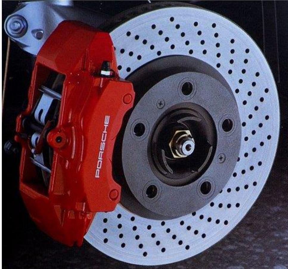
**Slika 6. Disk kočnice [8]**
