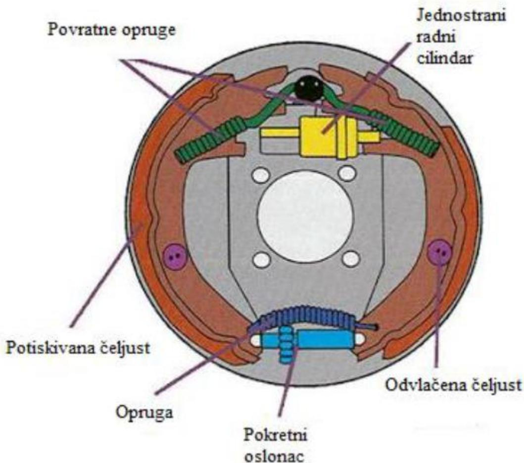
**Slika 9. Simplex kočnice [11]**
