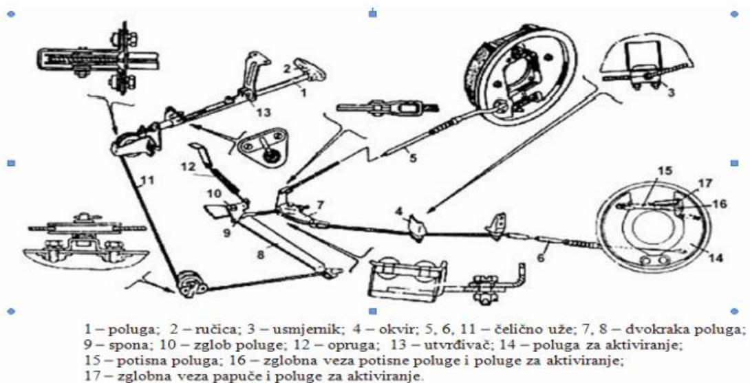
Slika 17. Mehanički sustav [26]
