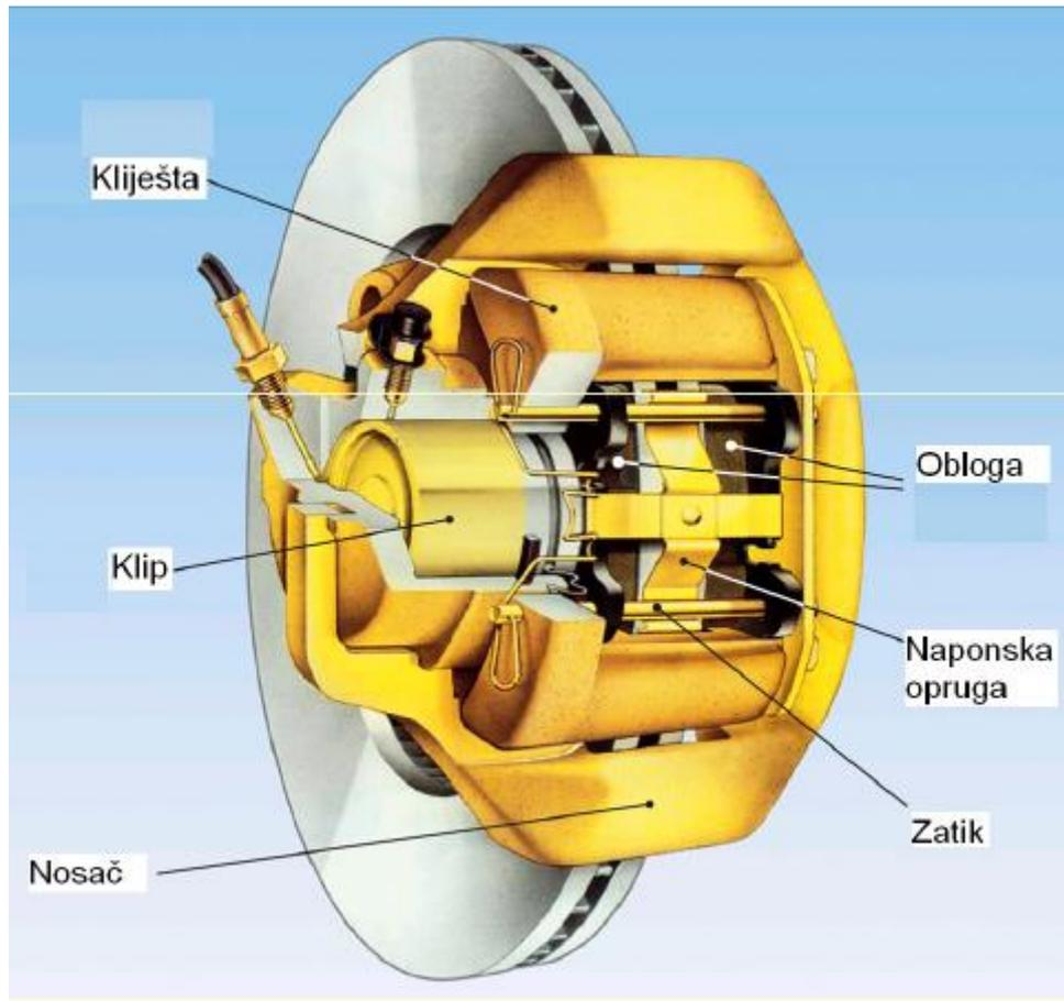
**Slika 5. Disk kočnice [2]**
