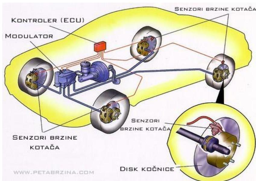
Slika 23. Način rada ABS sustava [15]
