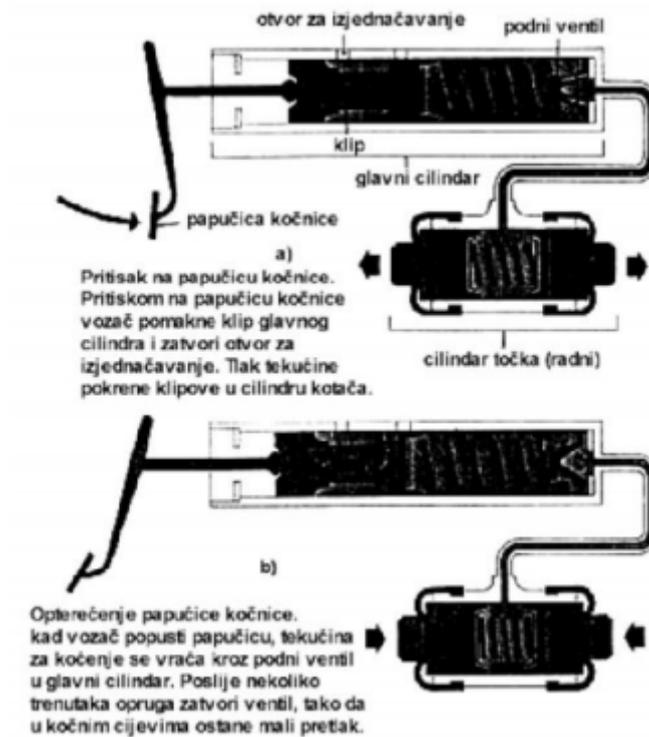
**Slika 20. Veza radnog cilindra s glavnim kočionim cilindrom [27]**
