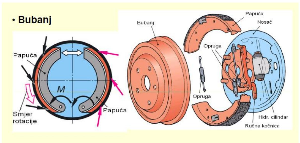
Slika 7. Bubanj kočnice [2]
