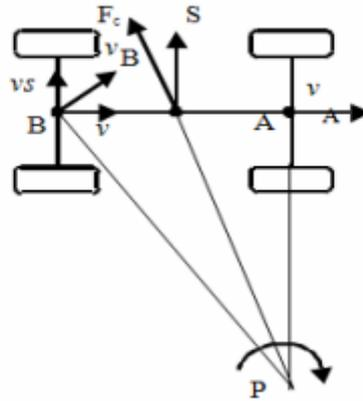
**Slika 15. Vozilo sa blokiranjem stražnjih kotača [20]**
