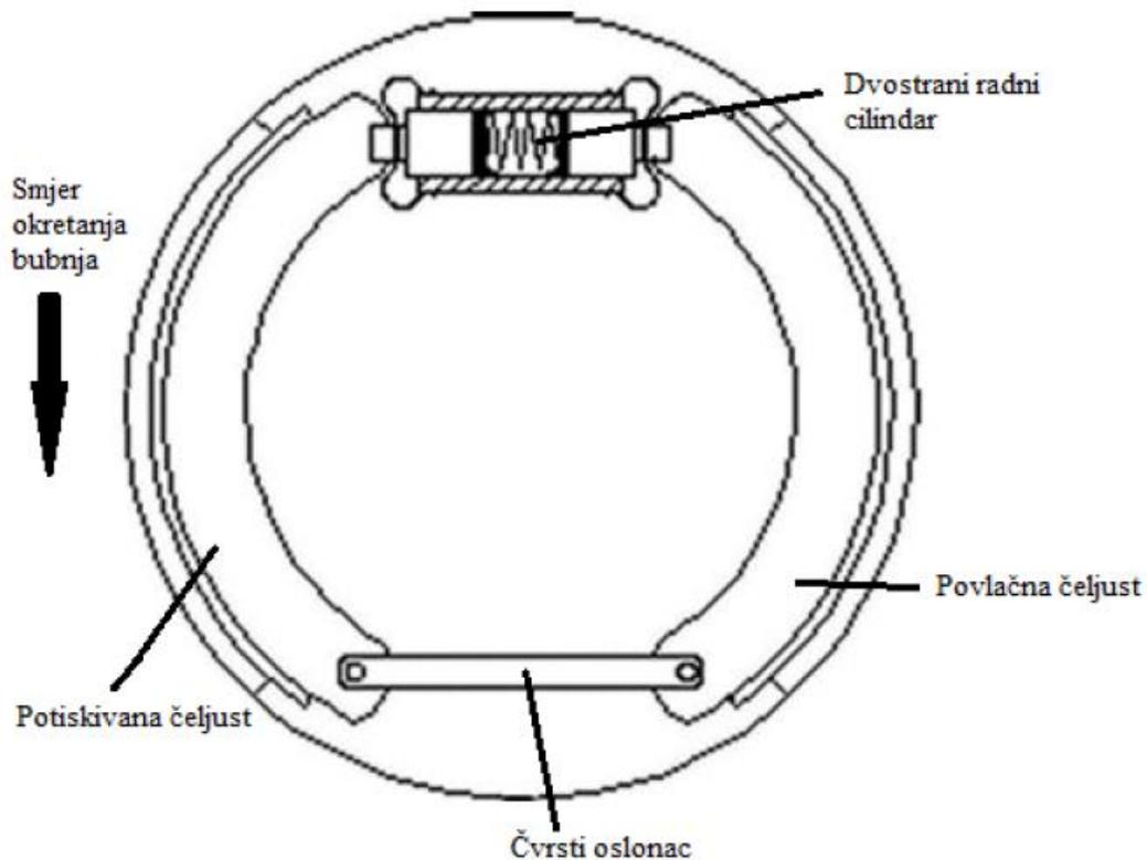
**Slika 8. Simplex kočnice [10]**
