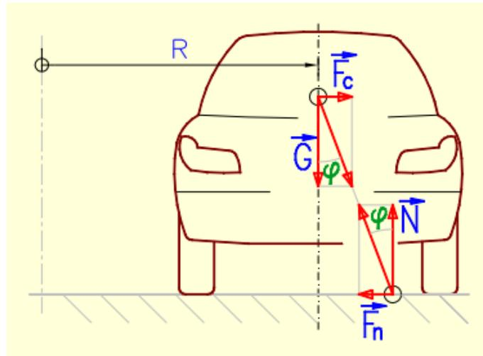
**Slika 5. Prikaz centrifugalne i centripetalne sile na vozilu[28]**
