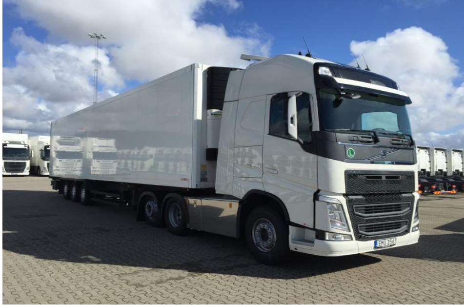
Slika 9. Kamion tegljač s tri osovine i poluprikolicom s tri osovine s jednostrukim gumama
