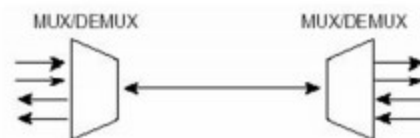
Slika 16. Dvosmjerni DWDM sustav
